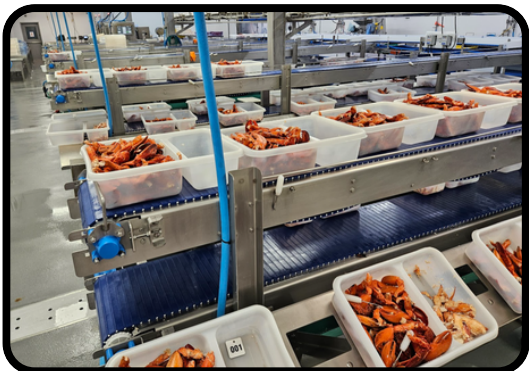
Convoyeur double pour les tables de tri des produits de la mer
